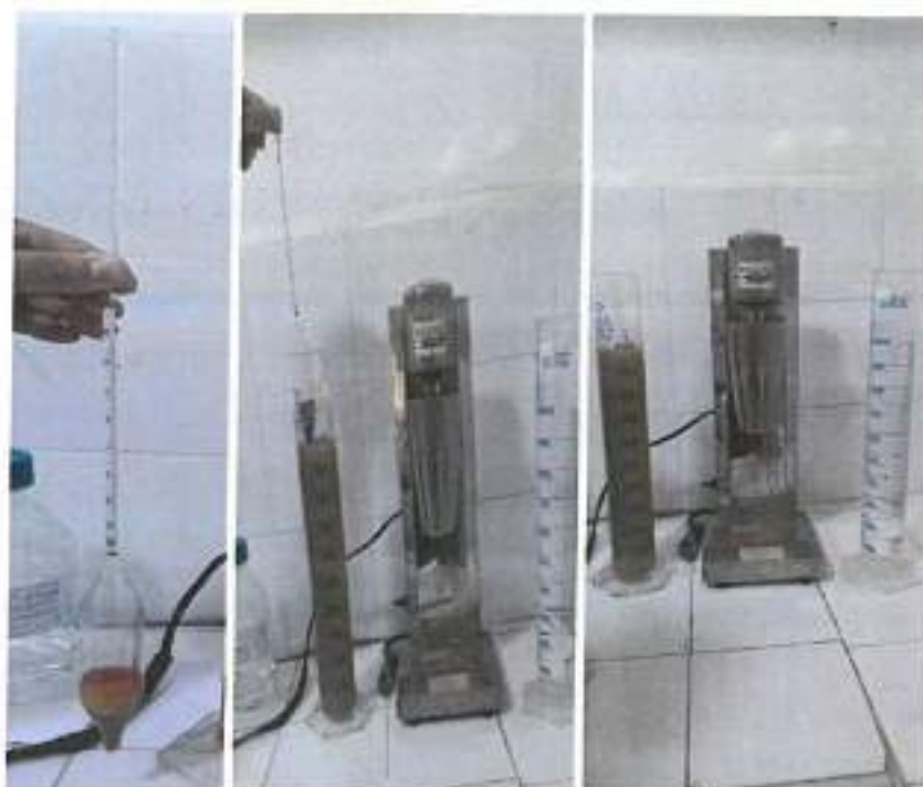
Fig 1 : Densimètre et éprouvette pour essai de sédimentation.
