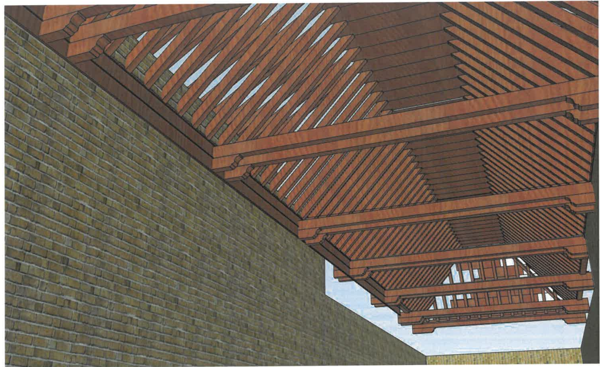
Type du plancher en bois de cèdre (Berchela)
