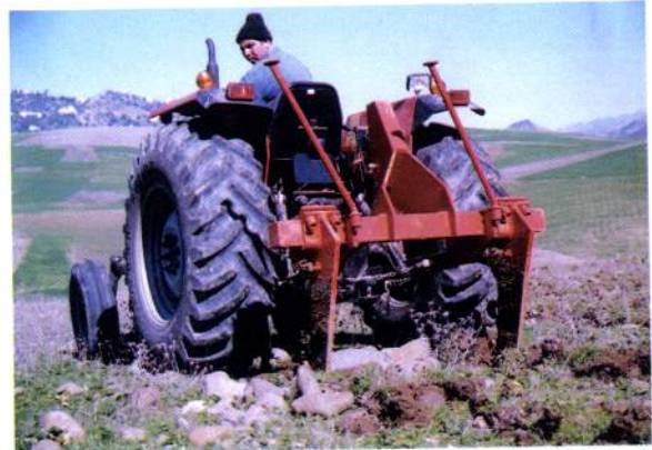
عملية الاستصلاح وتنقية من الأحجار بمحراث من نوع Sous soleur
